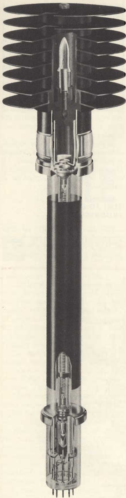
Fig. 3 - Foto illustrante la composizione di un tubo ad onde progressive della Philips modello 7537 adatto per frequenze da 4400 a 5000 MHz.
