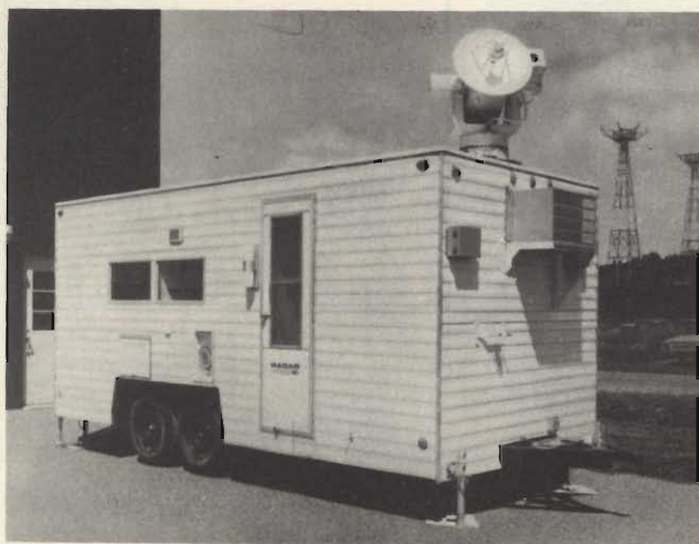
Fig. 1 - Radar della SIERRA Research Corp. per collegamenti con satelliti meteorologici, installato a bordo di un mezzo mobile.
