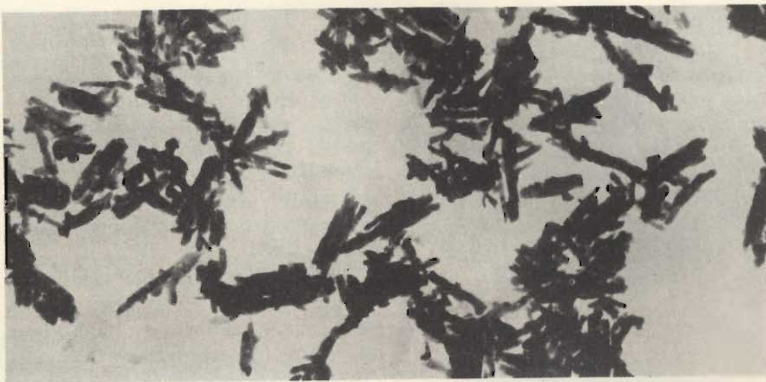
Le particelle d'ossido su di un nastro magnetico ingrandito 20.000 volte (per concessione dell'Amplex).
