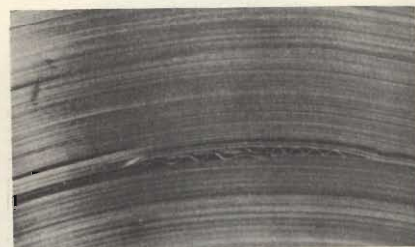
Danno causato dallo scorrimento tra i vari strati.
